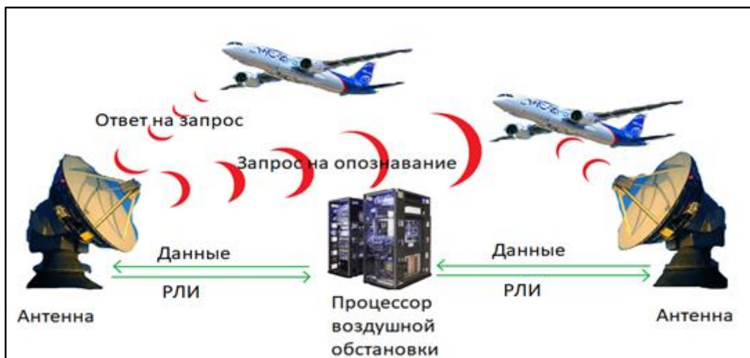
Рисунок 1 – Принцип работы РЛС
