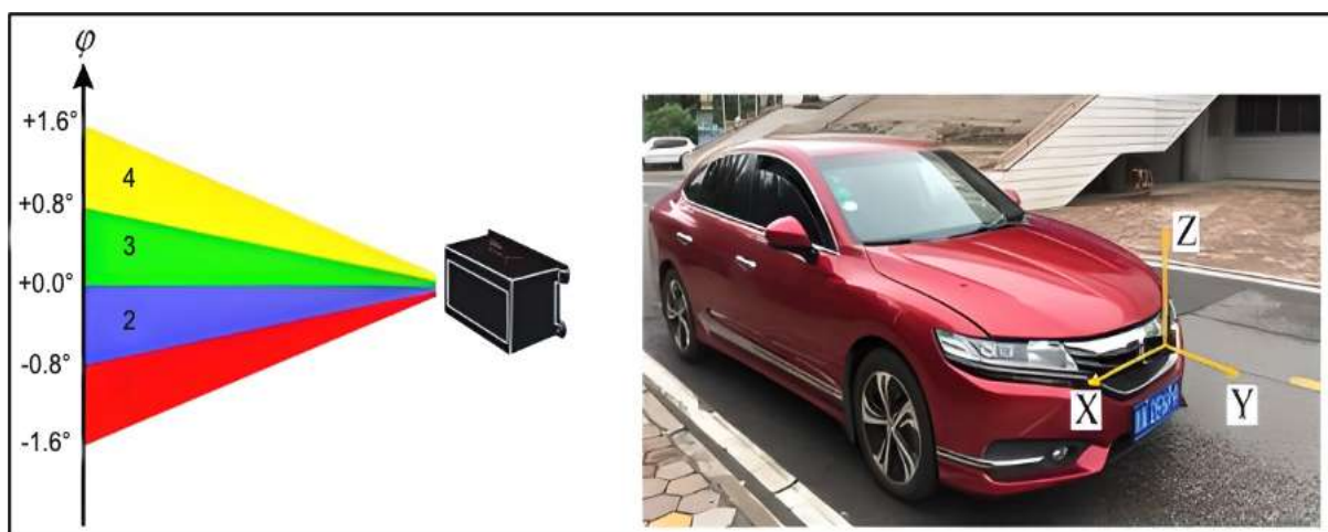
Рисунок 2 – Лазерный луч и сканер на транспортном средстве [5]
