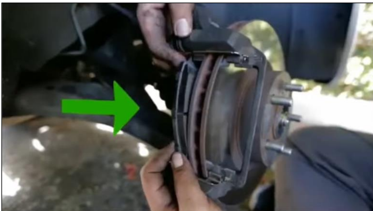
Рисунок 3 – Стоп-кадр анимированной иллюстрации установки тормозной колодки с визуальной подсказкой
