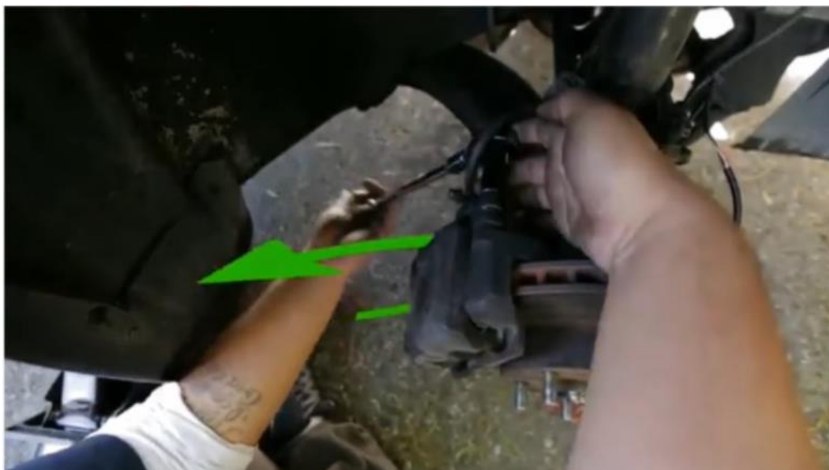
Рисунок 4 – Стоп-кадр анимированной иллюстрации снятия болтов суппорта с визуальной подсказкой
