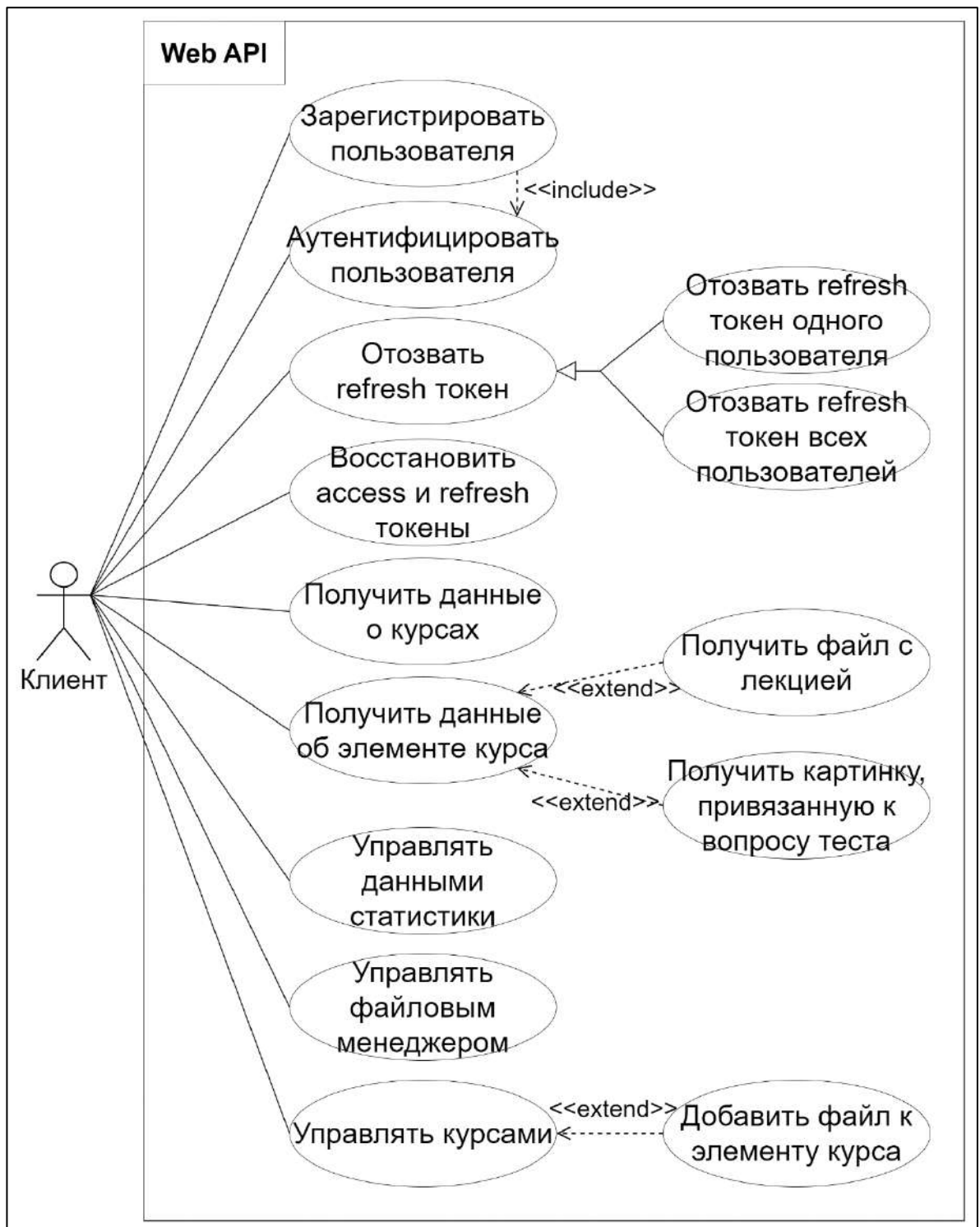
Рисунок 7 – Диаграмма вариантов использования серверного приложения для разрабатываемой системы
