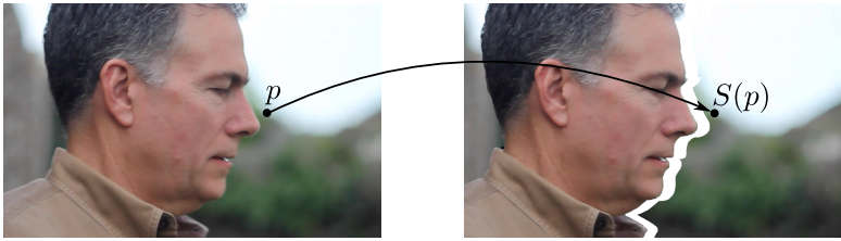
Рис. 6 — Пример отображения S , преобразующего исходный ракурс в целевой. В области целевого ракурса, обозначенной белым цветом, неизвестны значения цвета, так как в нее не отображается ни одна из точек исходного ракурса. Такая область называется областью открытия в целевом ракурсе. Одной из важных подзадач задачи построения стереоскопических ракурсов является задача вычисления цвета в областях открытия.
